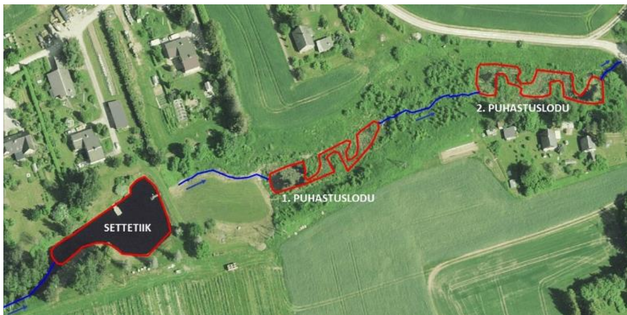
Vända tehismärgala kompleks Tartumaal, mis koosneb settetiigist ja sellest allavoolu paiknevast kahest madalaveelisest puhastuslodust (Rannap jt 2020 28 järgi).
