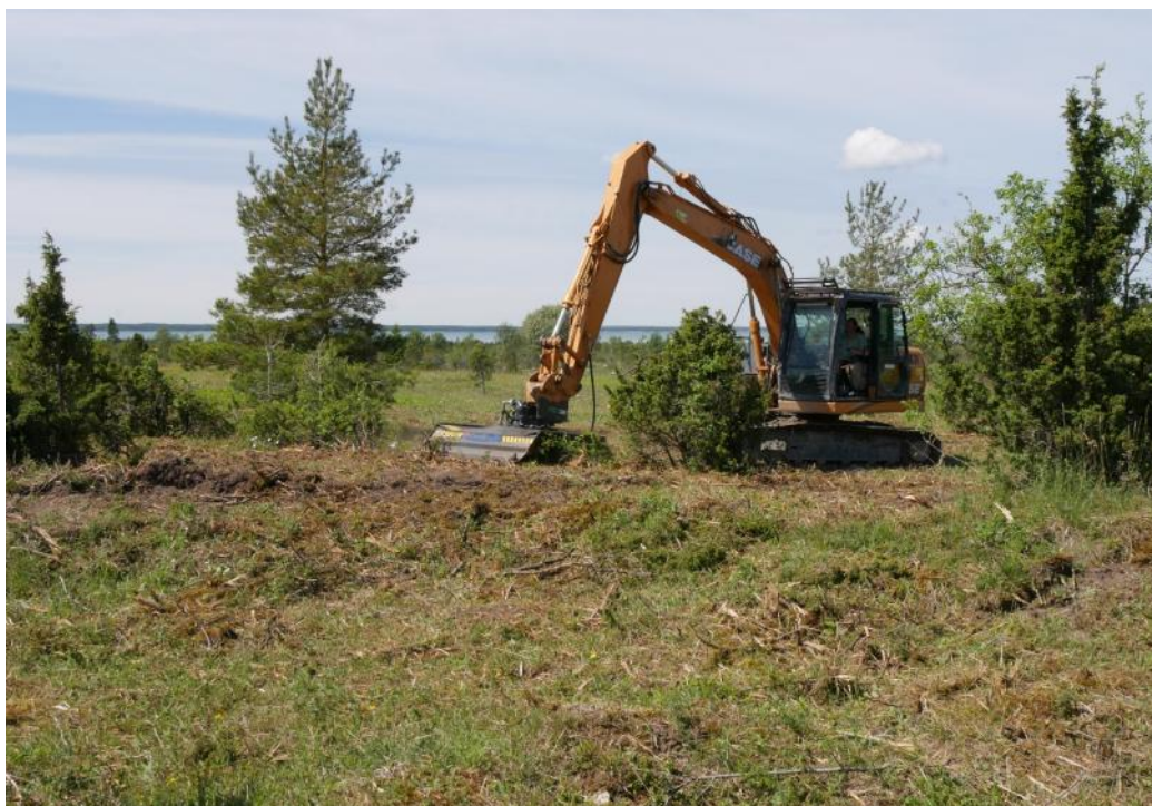
Ekskavaatorile kinnitatud kettpurusti aitab purustada madalaid kadakaid.
