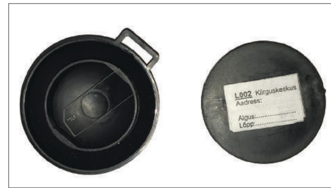
Toa siseõhu Rn-sisalduse määramiseks kasutatav detektor. Detector used for measuring Rn concentration in indoor air.
