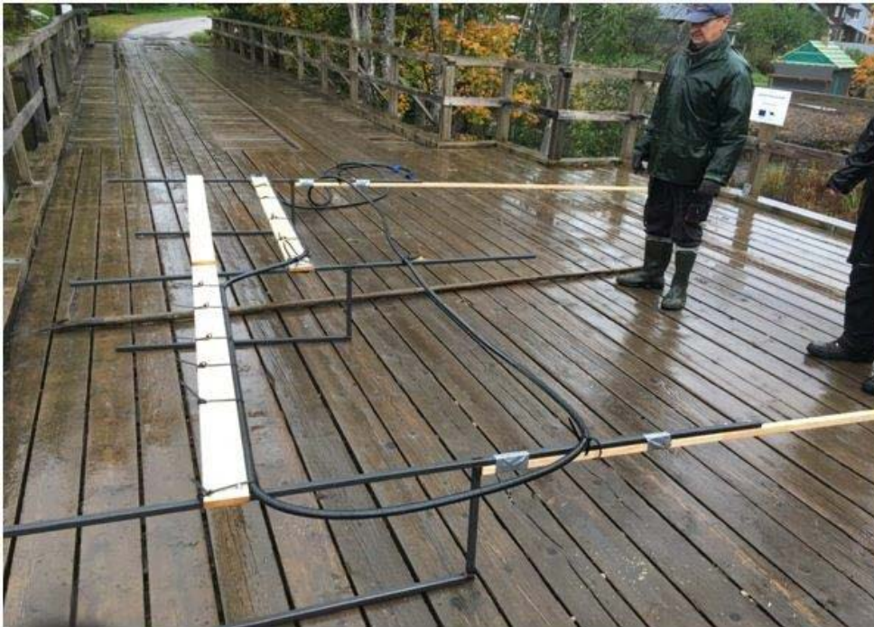
Foto 10. Märjistatud kalade loendamiseks paigaldati Joaveski kalapääsu sissevoolule spetsiaalne seade (IS1001 Cord Antenna System). Fotol seadme antenniosa.
