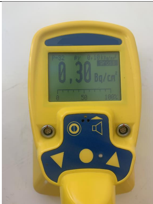
Joonis 4. Käsi-mõõteseade P-32 seadistuses näitamas väärtust ühikutes \text{Bq/cm}^2
