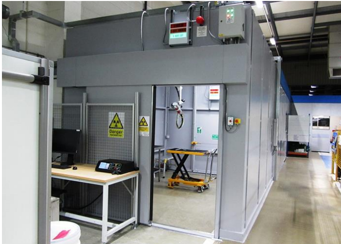
Joonis 3. Näide tööstusliku röntgenograafiaseadme varjestatud ruumist (foto: Calder Industrial ).
